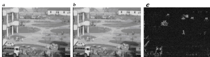
Fig.1: a,b - Pereche de imagini din zona de construcție a unei clădiri; c – Diferența dintre imaginile a și b.
